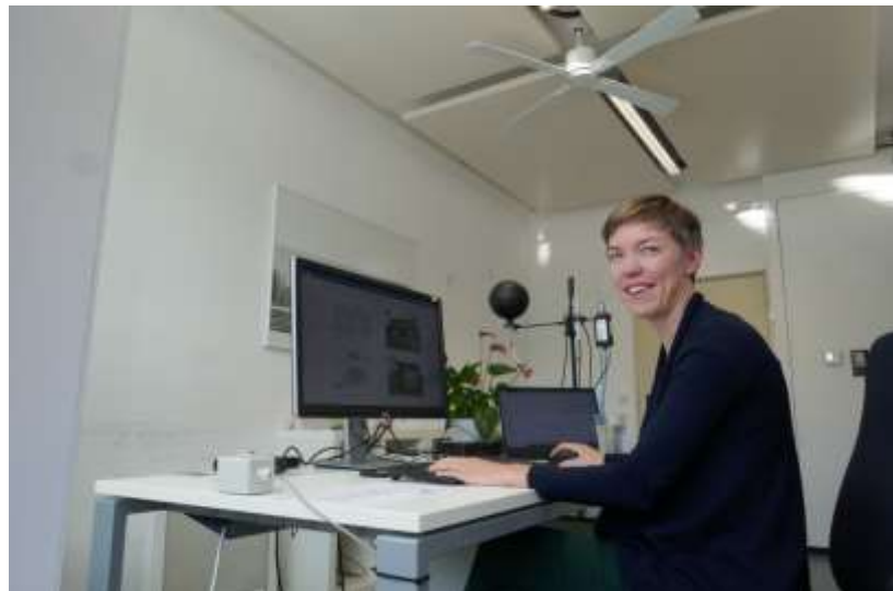
Abb. 20: Ansicht der Raumzelle „btga box“ (links) sowie Innenaufnahme (rechts) im Kontext von Versuchen zum Nutzungsverhalten bei erhöhten Raumtemperaturen. Im Hintergrund ist die Sensorik zum thermischen Komfort, auf dem Tisch ein Beleuchtungsstärkesensor erkennbar. (Quelle: Bergische Universität Wuppertal)
