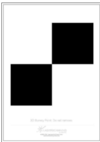
Abb. 5: Schachbrettzielmarke, Quelle: Lehr- und Forschungsgebiet Baubetrieb und Bauwirtschaft der Bergischen Universität Wuppertal
